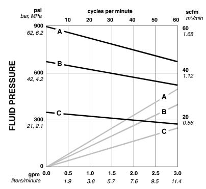
FLUID FLOW (TEST FLUID: NO. 10 WEIGHT OIL)
