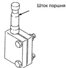
220 385 Комплект инструментов для корректной установки штока поршня HF насосов 309 136
