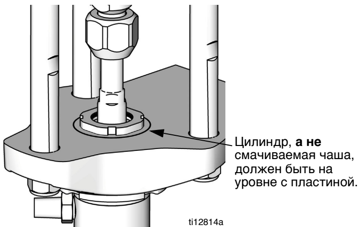
Рис.6. Выровняйте пластину переходника и цилиндр.
