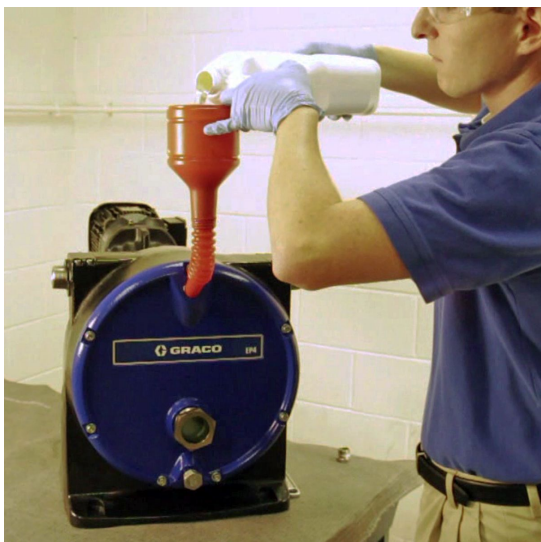
Figure 4 Заполнение насоса смазочным маслом для шланга
