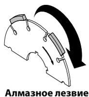
Модели **DC89** и **DC1013** предназначены для шлифовки с вращением барабана по направлению движения демаркировщика, а модель **DC1021** — против направления его движения.
